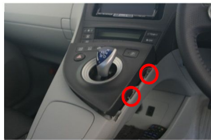
2/○印の場所にヘラ等を挿し込みパネルを外します
