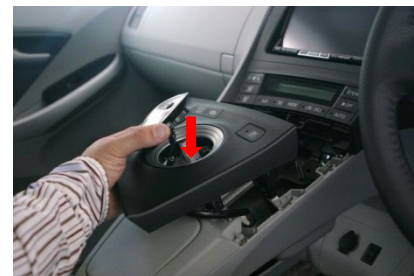
6/外したパネルの丸い部分に 上から製品のハーネスを通します
