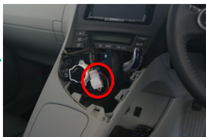
5/○印のシフトユニットの カプラーを外します
