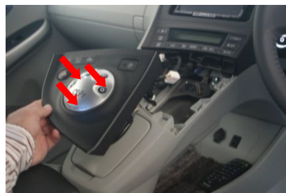
7/製品の裏側にあるツメを パネルにしっかりとはめて下さい
